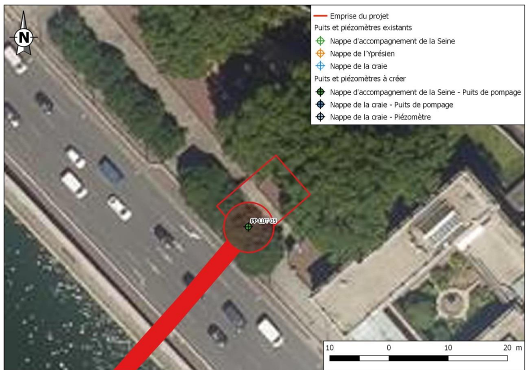
Figure 29 : Localisation des ouvrages envisagés pour les opérations de rabattement de nappe au niveau du puits en rive droite - voie Mazas (fond : IGN BD ORTHO®)
