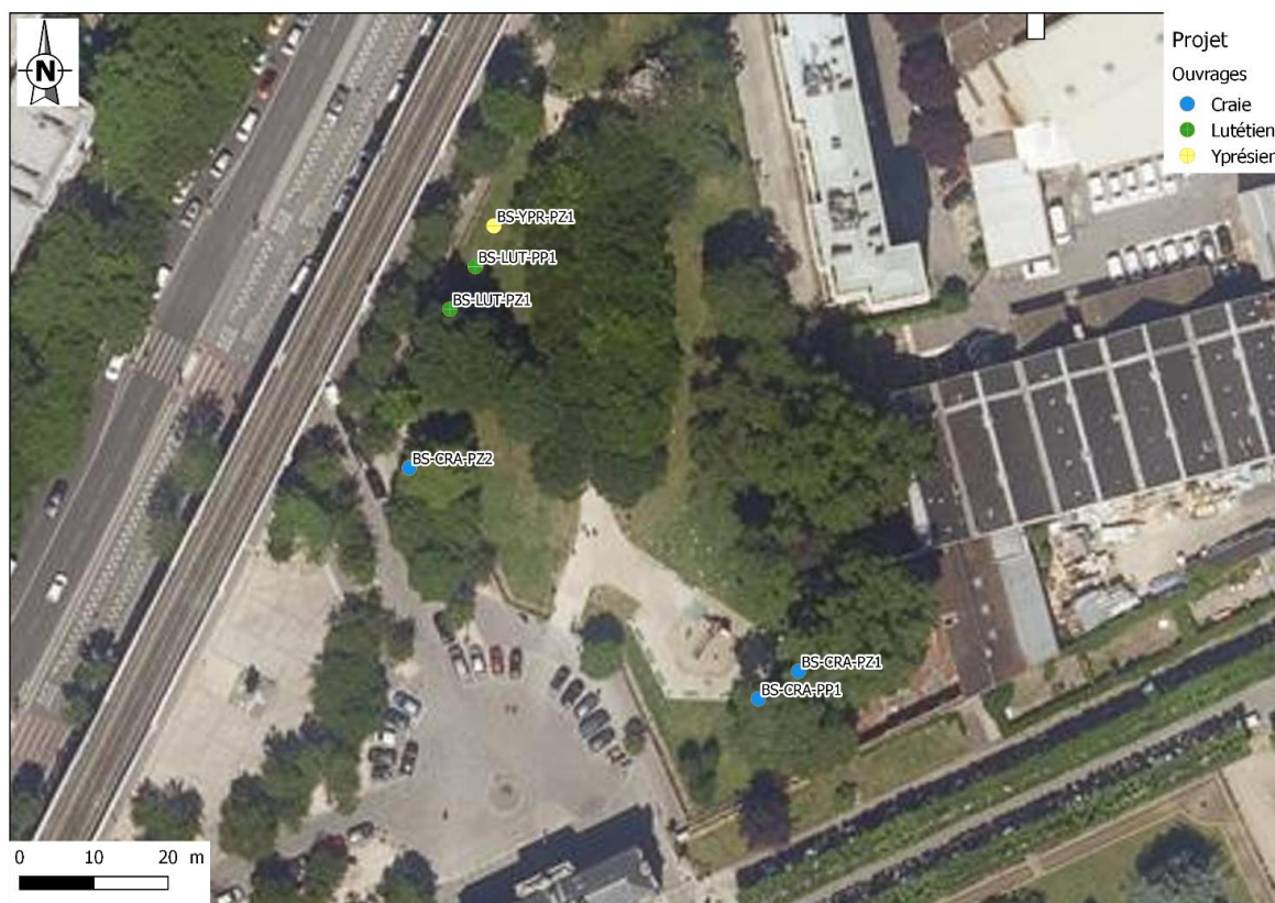
Figure 76 - Localisation des puits et des piézomètres réalisés sur le site du square Marie Curie (fond : IGN BD ORTHO®)
